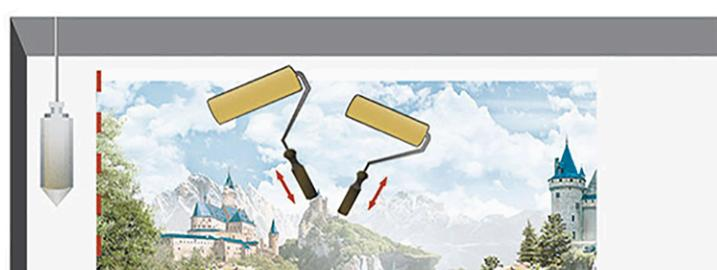
Движениями от середины полотна вверх вниз и в стороны разгладьте, прокатайте сухим и чистым обояным резиновым валиком, удаляя воздух из-под полотна для плотного прилегания полотна к стене.
